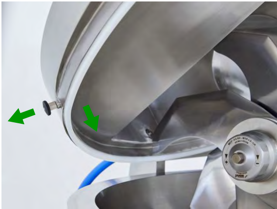
Bande de friction du couvercle/cuve démontable pour faciliter le nettoyage.
