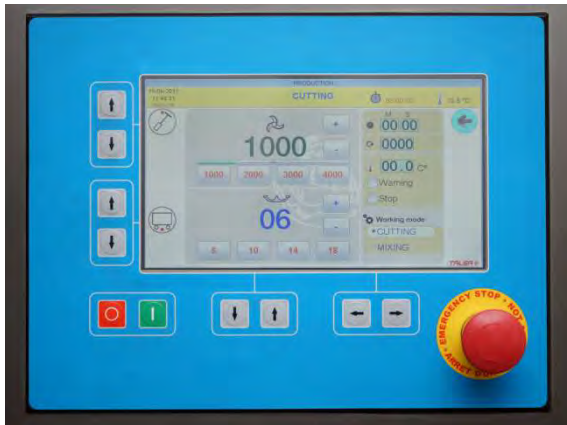
Écran numérique de contrôle et de programmation pour toutes les fonctionnalités du cutter.
