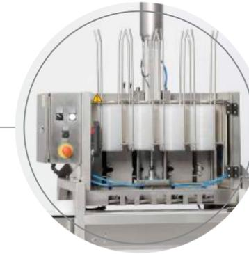
Ein **Schalenentstapler** positioniert automatisch Schalen auf dem Einlaufband.
