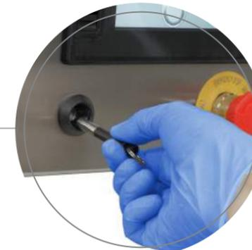
Der **manipulationssichere Benutzer-Identifikationsstift** teilt individuelle Benutzerrechte ein und unterstützt dabei Produktionsprozesse sicher und transparent abzuwickeln. Der Verpackungsprozess muss bei einem Benutzerwechsel nicht unterbrochen werden.
