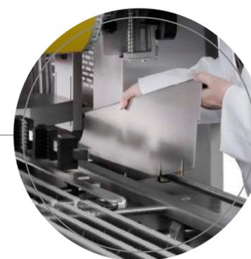
Mit der **Positionierschablone** wird ein schnelles und zeitsparendes Einstellen der Schalenerfassung (**Fiber Optics**) für jeden Werkzeugsatz sichergestellt.
