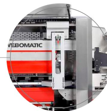
**Servo-angetriebene Greiferarme** erlauben eine akkurate Schalenpositionierung in die Siegelkammer.
